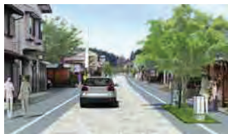
中尊寺通り (み泉町) 車道中央部のみ石張り舗装とすることでイメージ狭さくを喚起
